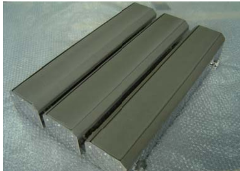
タイヤの原料となる生ゴムなど高粘着物のラインへの付着という課題は、表面に凸凹をつけた独自の「タックフリーコーティング」の開発で解決。
