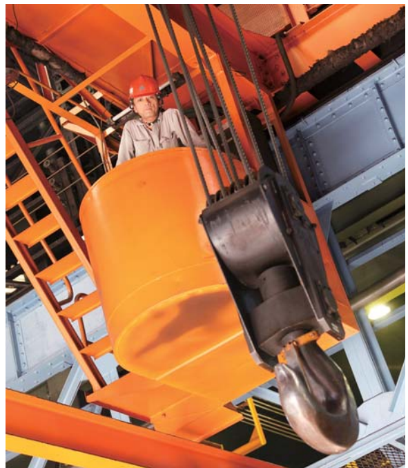
35トンクレーンも装備している。
